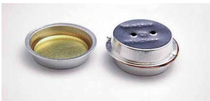
A tesztet egy lefedett kis edénnyel, a lánc üzemi körülményeit szimulálva végzik.
