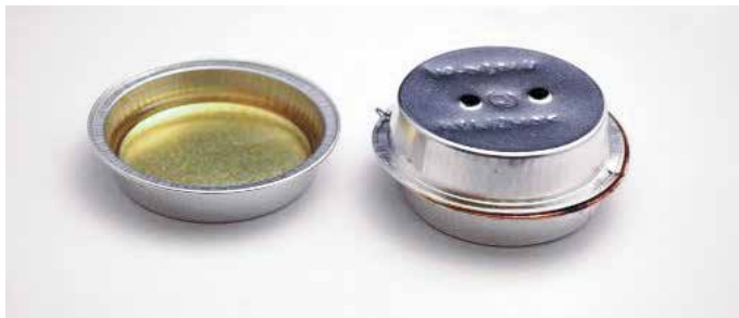
Testul este efectuat utilizând un vas acoperit simulând condițiile de lucru ale lanțului.
