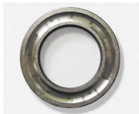
SNR-FEB-2-Test: Klüberplex BEM 41-141 erreicht die maximale Laufzeit von 50 Stunden
