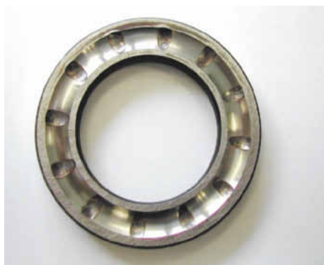
SNR-FEB-2-Wälzlagerfett-Test, Wettbewerbsprodukt 1: Wegen Überschreitung der Verschleißwerte wurde der Test nach 13,5 Stunden abgebrochen
