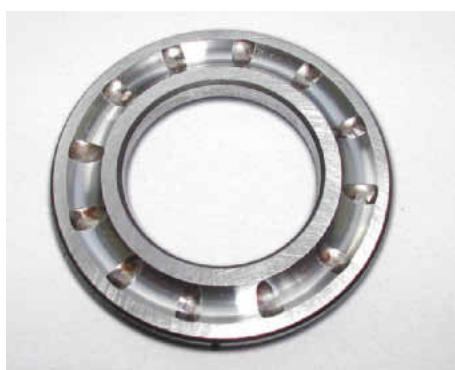
SNR-FEB-2-Test, Wettbewerbsprodukt 2: Wegen Überschreitung der Verschleißwerte wurde der Test nach 39,6 Stunden abgebrochen
