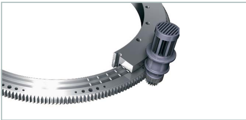
Bei solchen Verzahnungen der offenen Azimut- und Blattlagerantriebe besteht die Gefahr, dass der Schmierstoff von der Verzahnung abtropft. Die daraus resultierende Mangelschmierung und die Verschmutzung von Gondel und Turm sind mithilfe eines weißen Haftschmierstoffs mit hoher Trag- und Haftfähigkeit vermeidbar
