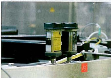
Klübermatic-Schmierstoffgeber: versorgen Anlagen und Bauteile automatisch mit dem richtigen Schmierstoff
