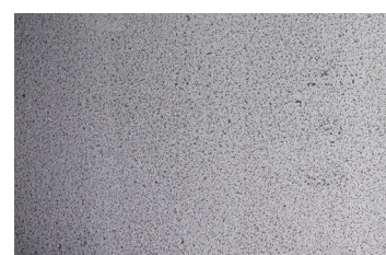
Lusin® Protect G 31 F >150 Stunden in der Salzsprühkammer
