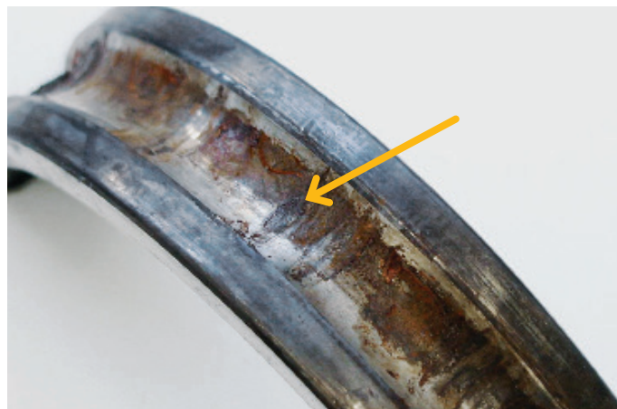
Segni d'usura causati dalle vibrazioni dei cuscinetti stazionari - il cosiddetto False Brinelling
